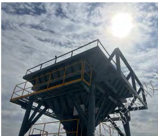
材料码头装卸平台湿式抑尘装置
